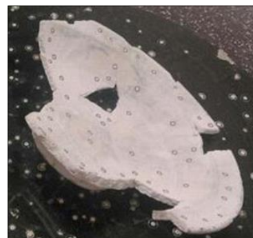
تصویر ۶-الف: میز چرخان اسکنر و قطعه سفالی با تارگت‌های الصاق شده
