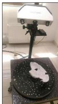
تصویر ۶-ب: اسکن قطعه روی میز چرخان تارگت‌گذاری شده
